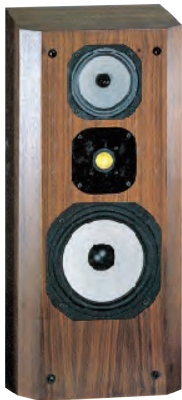
Fig.16 All'interno di una Cassa Acustica vengono applicati più altoparlanti per poter coprire tutta la gamma audio da 20 Hz a 20.000 Hz. Il grosso altoparlante chiamato Woofers si utilizza per riprodurre le note dei Bassi, l'altoparlante di dimensioni inferiori chiamato Midrange per riprodurre le note dei Medi ed il minuscolo altoparlante chiamato Tweeter per riprodurre le note degli Acuti. E' poi il filtro Crossover che provvede a far giungere sui tre altoparlanti le sole frequenze che sono in grado di riprodurre.
