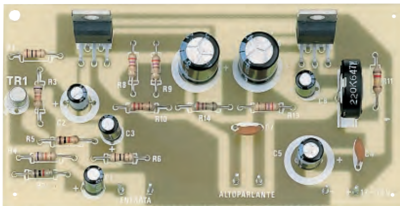
Fig.5 Foto del circuito a realizzazione completata. Se nel montaggio rispetterete la polarità +/- dei terminali dei 7 condensatori elettrolitici, il circuito funzionerà appena completato. I circuiti stampati che vi forniamo sono tutti in fibra di vetro, già forati e completi di disegno serigrafico e di una vernice protettiva, che qui non appare.
