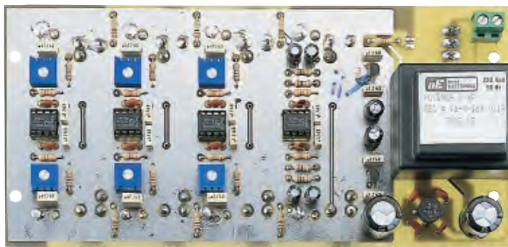
Fig.3 Foto vista dal lato dei componenti. Notate i trimmer di taratura e lo stadio di alimentazione.
