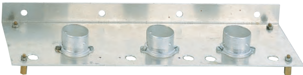
Fig.18 Per tenere distanziato il circuito stampato dalle due squadrette ad L, dovrete usare i distanziatori in ottone che troverete inseriti nel kit. Questi distanziatori servono anche per collegare a massa le piste in rame del circuito stampato.
