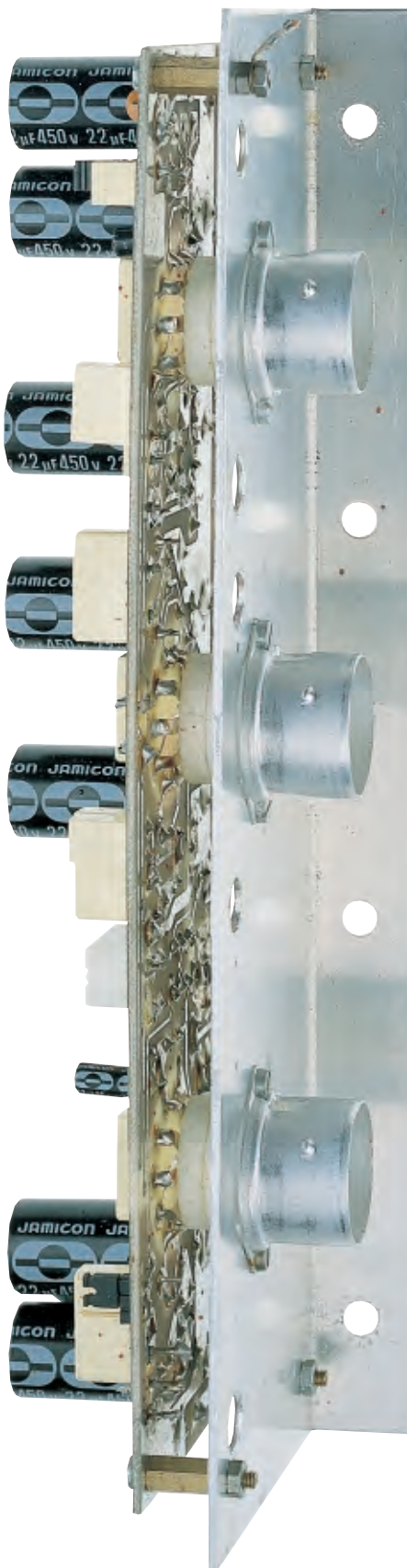
Fig.23 Foto vista di taglio dello stampato LX.1140 fissato con i distanziatori metallici sul supporto ad L.
