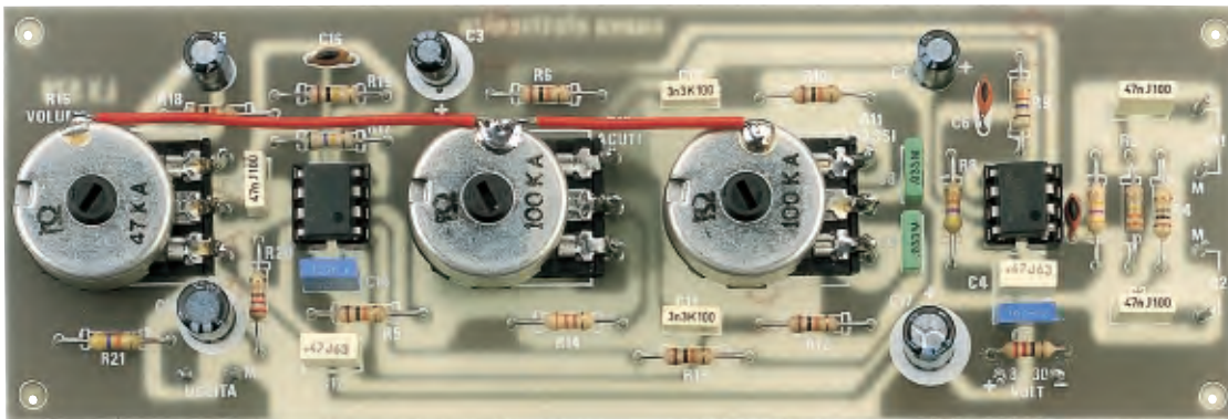
Fig.1 Foto del preamplificatore Mono LX.579 descritto nell'articolo. Non abbiamo applicato sul circuito stampato i due potenziometri R1-R2 (vedi fig.3) che regolano la sensibilità d'ingresso, perché potrete sostituirli con due trimmer che andranno direttamente fissati sul circuito stampato. Per applicare il segnale sull'ingresso e per prelevare dalla sua uscita così da farlo giungere ad un amplificatore di potenza, dovrete utilizzare del cavetto "schermato" collegando la calza di schermo a massa.
