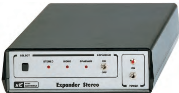
Fig.6 Il circuito viene racchiuso in un elegante mobile plastico di colore nero provvisto di un pannello già forato e serigrafato.
