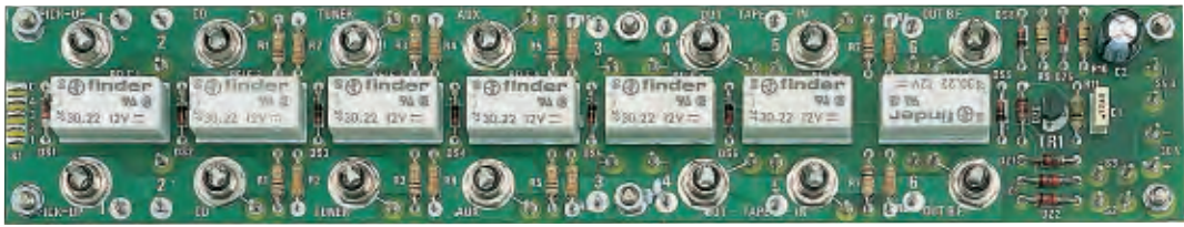
Fig.3 Foto dello stadio d'ingresso LX.1149 visto dal lato dei componenti. Per la realizzazione di questo stadio, che è già stereo, basta montare un solo circuito stampato.
