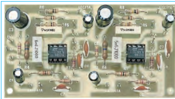
Fig.3 Foto di come si presenta il preamplificatore per pick-up con rete di equalizzazione RIAA montato in versione stereo.
